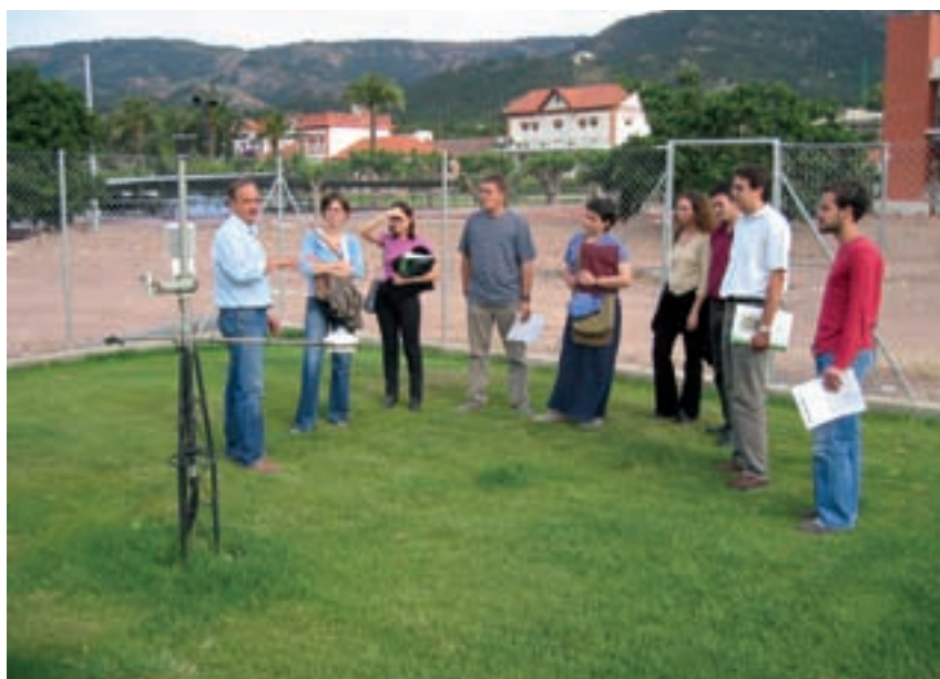
Detalle de una estación agrometeorológica. Los datos obtenidos de la misma sirven para calcular las necesidades de agua de los cultivos.
