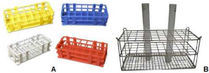
Gradillas: de plástico (A), metálica (B)
