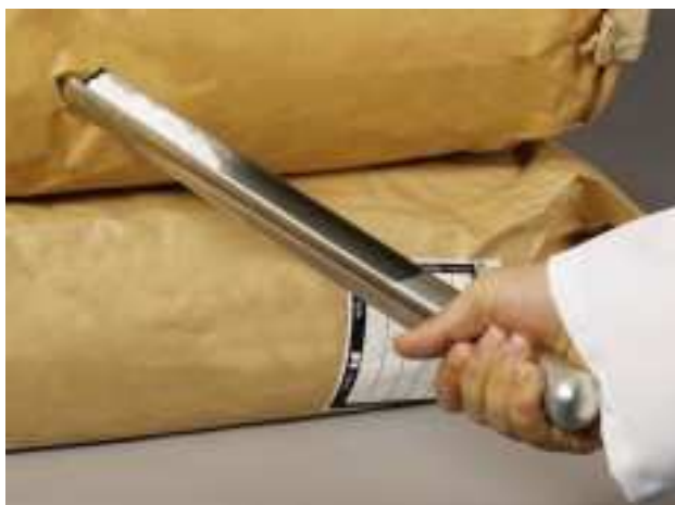
Muestreadores: (1) para leche en polvo (2) para productos congelados y hielo
