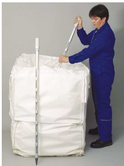
Muestreador para alimentos a granel sólidos en polvo o pequeño tamaño de partícula (imagen de http://www.buerkle.de/es/shop/_muestreadores.html )
