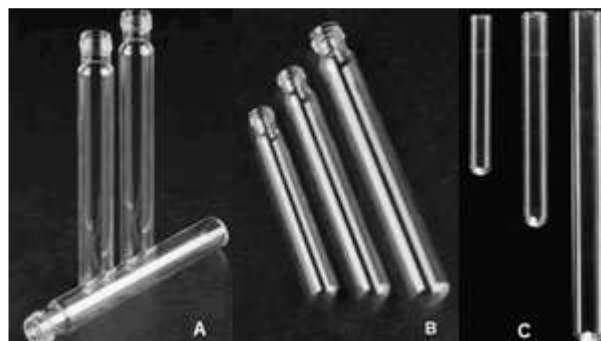
Tubos: con tapón de rosca, de fondo plano (A), fondo redondo (B). Tubos de ensayo (C)
