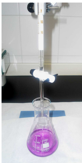
Disposición de la bureta y disolución con el indicador
