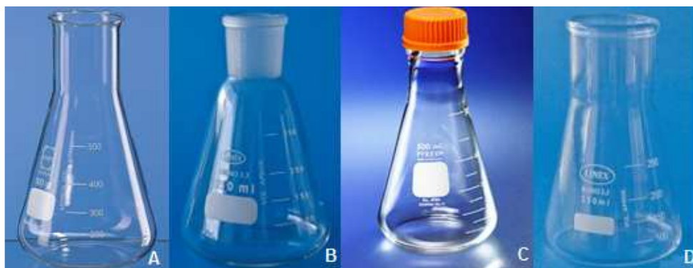
Matraces erlenmeyer: matraz erlenmeyer (A), con cuello esmerilado (B), con tapón de rosca (C), de boca ancha (D).
